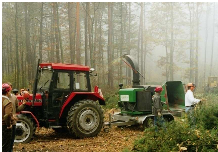
10.4. Nadleśnictwo Rogów. Zrębkowanie gałęzi jako forma przygotowania terenu do odnowień
